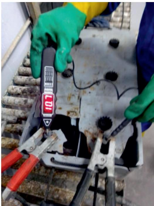
Patlamış olan bir akü. Akü 12.0 V göstermektedir. Aküden akü test cihazı (Şönt) ile amper çekildiğinde akü voltajı 10.7 V göstermektedir. Akü sağlamdır.
