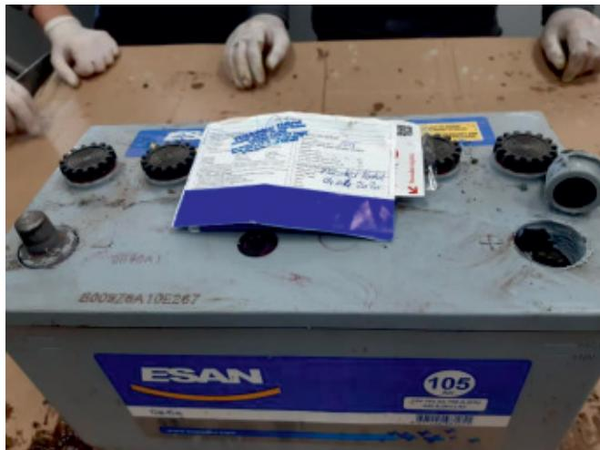
Buşonlu bir akü indikatör göz yeşil, açık devre voltajı 12.20-12.80 V, elektrolit yoğunluğu 1,25-1,28 g/cm<sup>3</sup>, aküden amper çekildiğinde voltaj 10.2 V dan daha fazla yükselmiyor ise,
