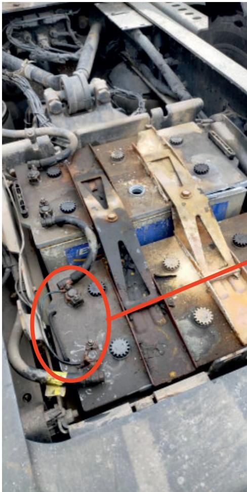
Çift akü kullanan araçlarda tek bir aküden ayrı bir çıkış yapılarak güç alınması halinde, akü grubunda voltaj dengesizliği olacağından ayrı güç alınan akünün aşırı yıpranmasına neden olur. Bu durum garanti kapsamı dışı bir durumdur.
