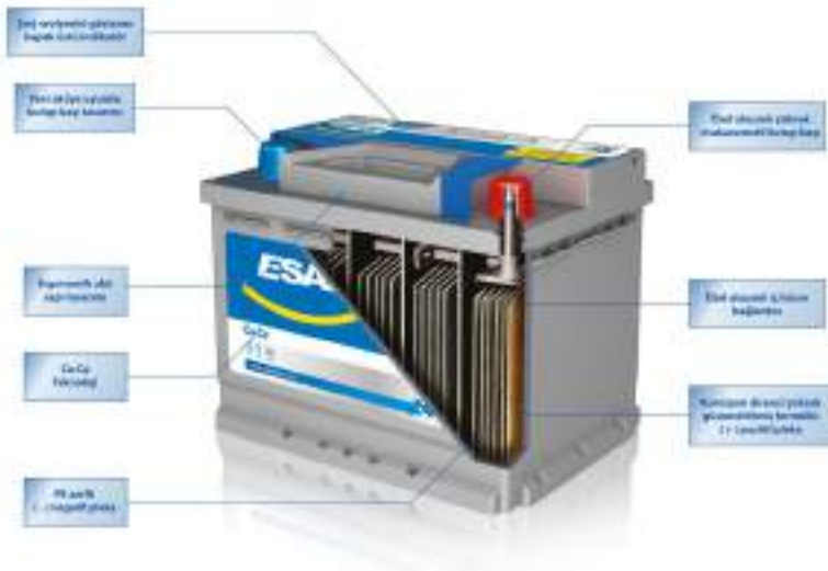
Şekil 2. Akümülatör Kesiti
